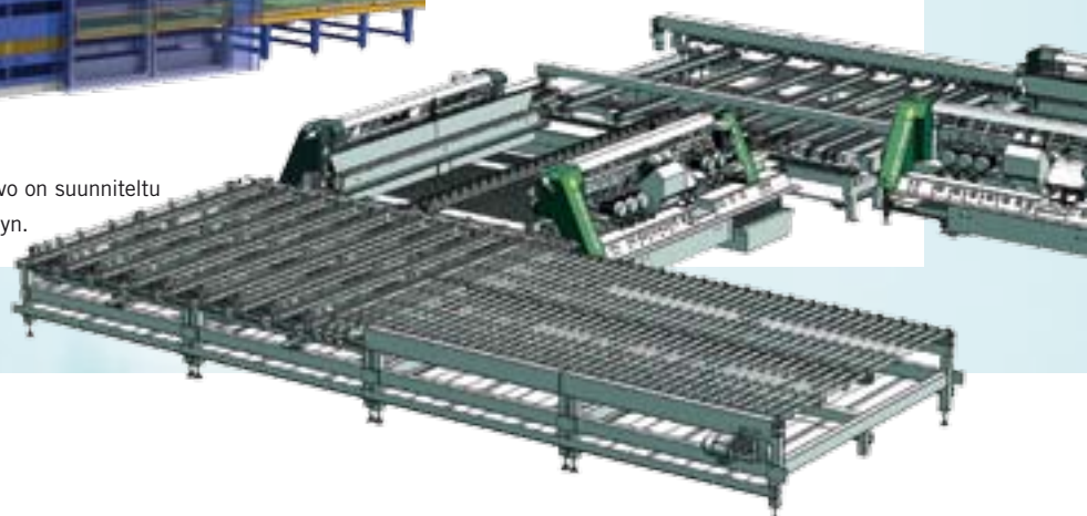
Tamglassin ProE-tasokarkaisukone soveltuu joustavasti kaikkien lasityyppien tehokkaaseen tuotantoon.
