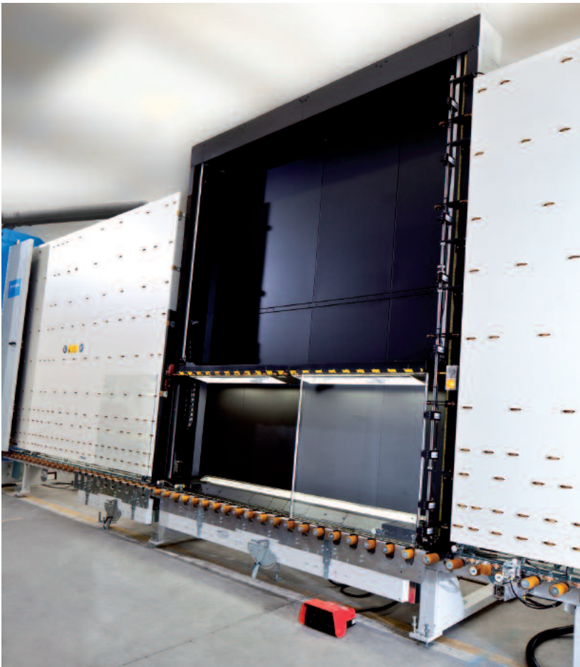
Réglage automatique des barres de butées de cadre pour les différentes épaisseurs de verre
