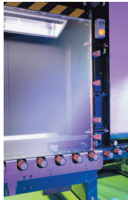
Réglage automatique des barres de butées de cadre pour les différentes épaisseurs de verre
