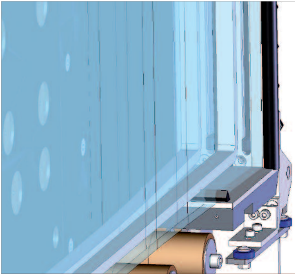
Befüllen der Dreifach-Isolierglaseinheit mit Edelgas
